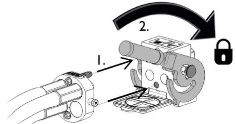
La leva deve potersi muovere facilmente fino alla posizione di bloccaggio. Se la leva non scorre in modo fluido, controllare l'allineamento e la posizione del connettore e pulire i connettori. Spegnerne anche la pala cariatrice e rilasciare la pressione idraulica residua.
